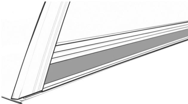
Закрываем монтажный паз в нижнем профиле, с помощью уплотнителя (заглушки паза).
