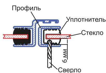
Сверловка бокового профиля для крепления упорных стоек.
