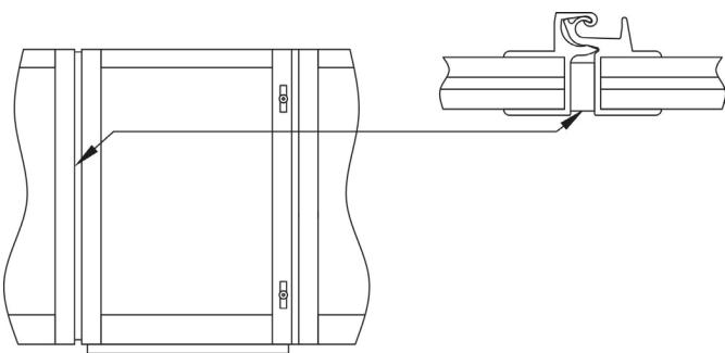
Наклеиваем уплотнитель 8x17 в проём калитки.
