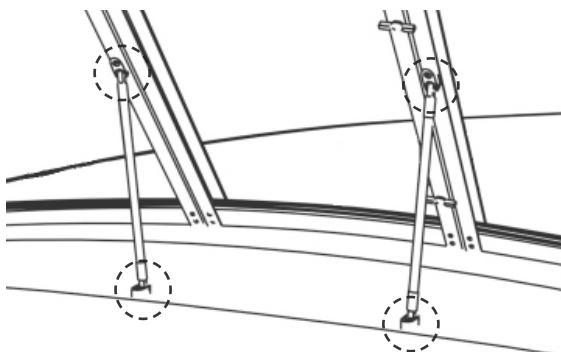
Устанавливаем упорные стойки, обеспечивая оптимальную геометрию створа калитки. Просверливаем места установки, после крепим на вытяжные заклепки.
