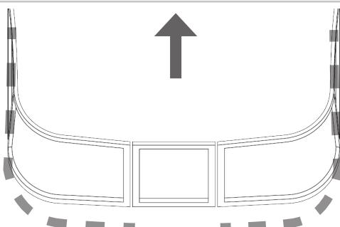
Откручиваем рамку от палубы лодки, приподнимаем её и располагаем под нижним профилем уплотнитель.
