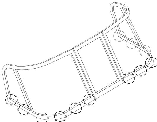
Устанавливаем рамку на место и фиксируем саморезами сквозь подготовленные ранее отверстия.
